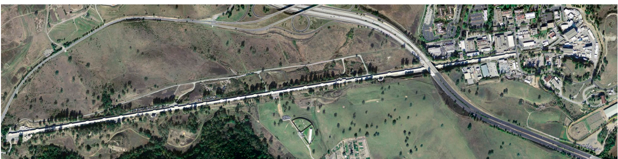
Abb. 12: Luftbild des bisher größten Linearbeschleunigers der Welt am SLAC (Stanford Linear Accelerator Center) in Kalifornien (Höchste Elektronenergie von 46 GeV bis 1998, heute Verwendung eines 1 km langen Teilstücks für die Linac Coherent Light Source - LCLS)
