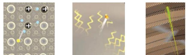
► **Elektrisch geladene Teilchen** erzeugen im Halbleiter-Detektor Elektron-Ion-Paare (links). Elektrisch geladene Teilchen erzeugen im Übergangsstrahlungsdetektor Photonen (Mitte). Energiereiche Teilchen erzeugen in den Kalorimetern Schauer aus niederenergetischen Teilchen (rechts).
