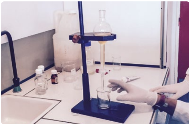
ABB. 3 Lösungsmittelextraktion des Koffeins
