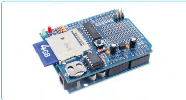
[6] 7: An Arduino gelötetes Data Logging Shield<sup>[4]</sup>
