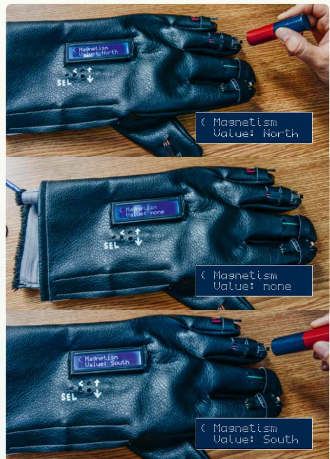
© 1a-c: Bestimmung der Pole eines Magneten
