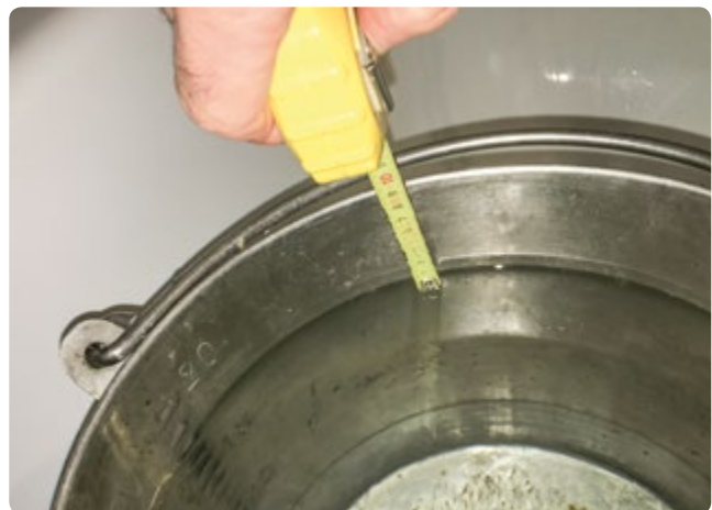
ABB. 2 Messung des Wasserstands zur Ermittlung des Wasservolumens
