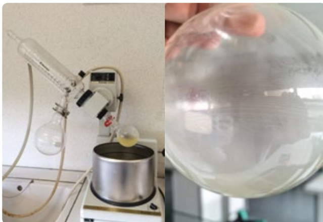
ABB. 8 Verdampfung des Lösungsmittels im Rotationsverdampfer [links] · Pulver am Rand des Kolbens nach der Verdampfung des Lösungsmittels
