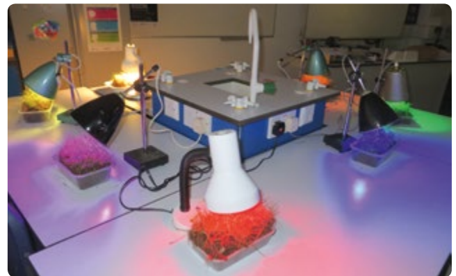
ABB. 9 Die Grasschalen wurden sechs Tage lang mit verschiedenfarbigem Licht beleuchtet, bevor das Gras geschnitten und die frische Masse als Maß für die Wachstumsrate gemessen wurde.
