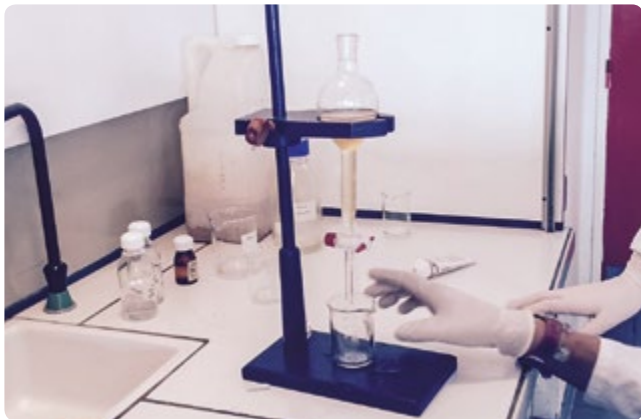
ABB. 3 Lösungsmittelextraktion des Koffeins
