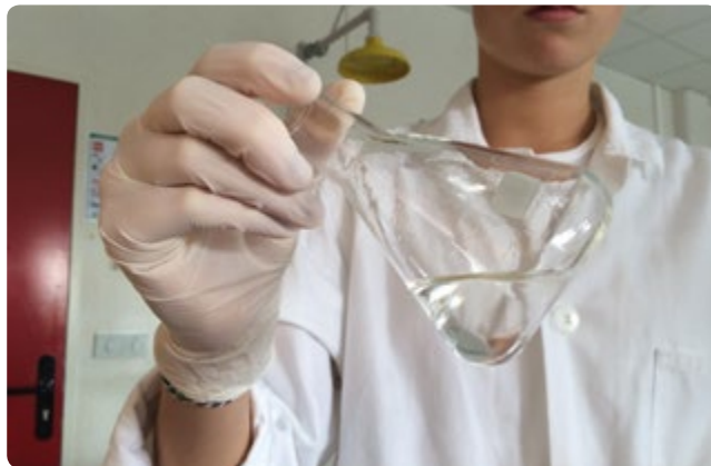
ABB. 4 Trocknung der organischen Phase mit einem Trockenmittel
