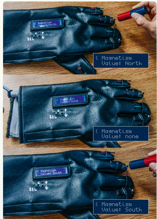
© 1a-c: Bestimmung der Pole eines Magneten
