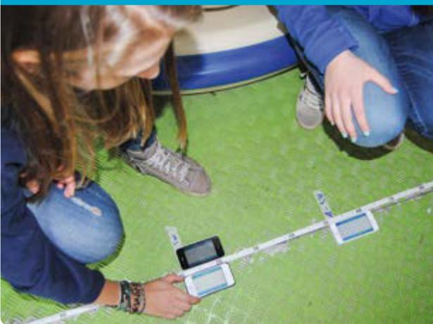
Die App zur Beschleunigungsmessung starten und das Smartphone auf einen der markierten Punkte legen, und zwar so, dass es entlang der radialen Richtung liegt.
