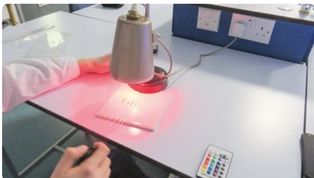
ABB. 8 Die Versuchs- und die Farbreferenzröhrchen wurden mit unterschiedlich gefärbtem Licht beleuchtet. Dabei wurde die Zeit für die Farbangleichung als Hinweis für die Rate der Entfärbung von DCPIP und somit die Fotosyntheserate festgehalten.
