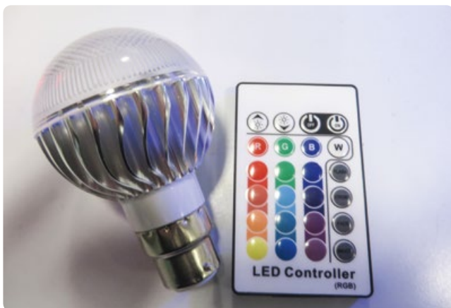
ABB. 5 Die Lampen wurden mit RGB 3W B22 LED-Birnen und je einer Fernbedienung ausgestattet, um die Lichtfarbe auf rot, orange, gelb, grün, blau, violett oder weiß einzustellen.
