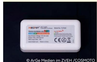
**1B** Wenn der LED-Streifen richtig angeschlossen ist und der Controller noch nicht mit der Fernbedienung verbunden war, leuchtet euer LED-Streifen dann rot.
