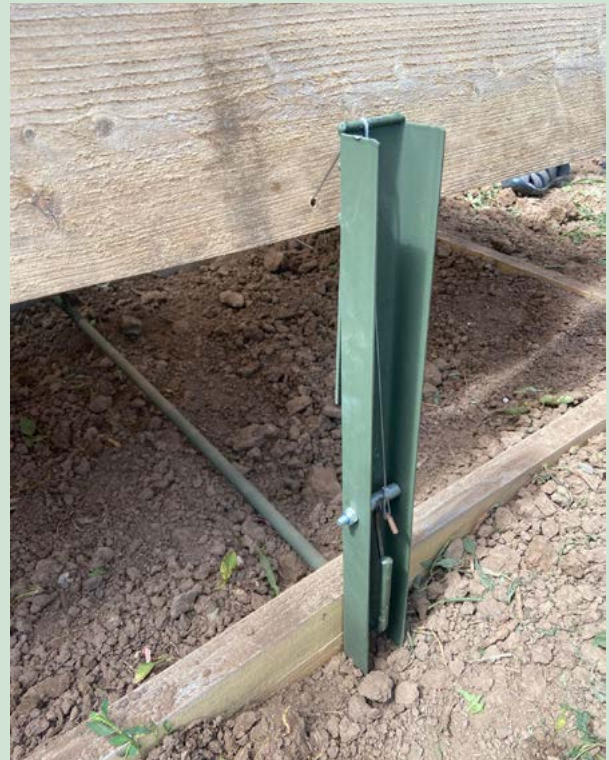
Ein Fallenschloss: ein möglicher Auslösemechanismus einer Kofferfalle
