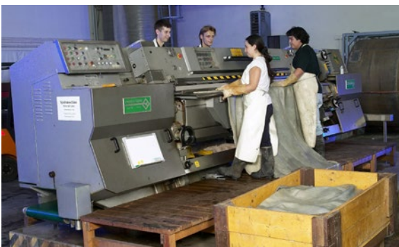
Abbildung 7: Arbeit an der Spaltmaschine
