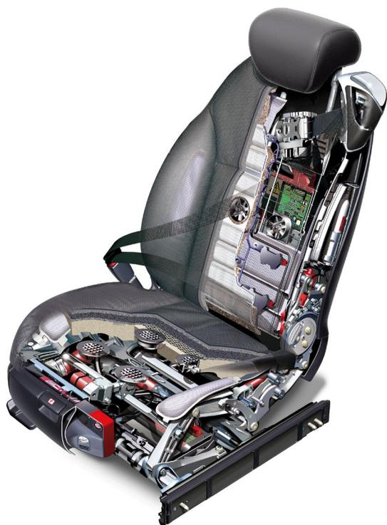
Abbildung 10: Schnittmodell eines Fahrzeugsitzes
