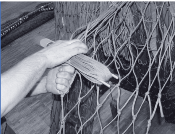
Zusammenstricken von Netzteilen
