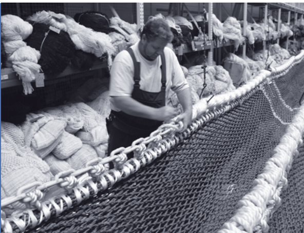
Befestigen der Laschenverstärkung an der Lasche
