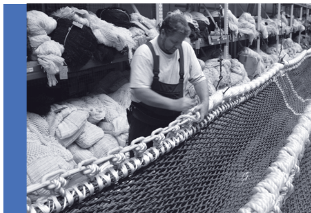
Bewickeln einer Laschenverstärkung aus Kette am Steert
