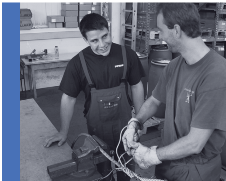
Spleißen eines Drahtseils
