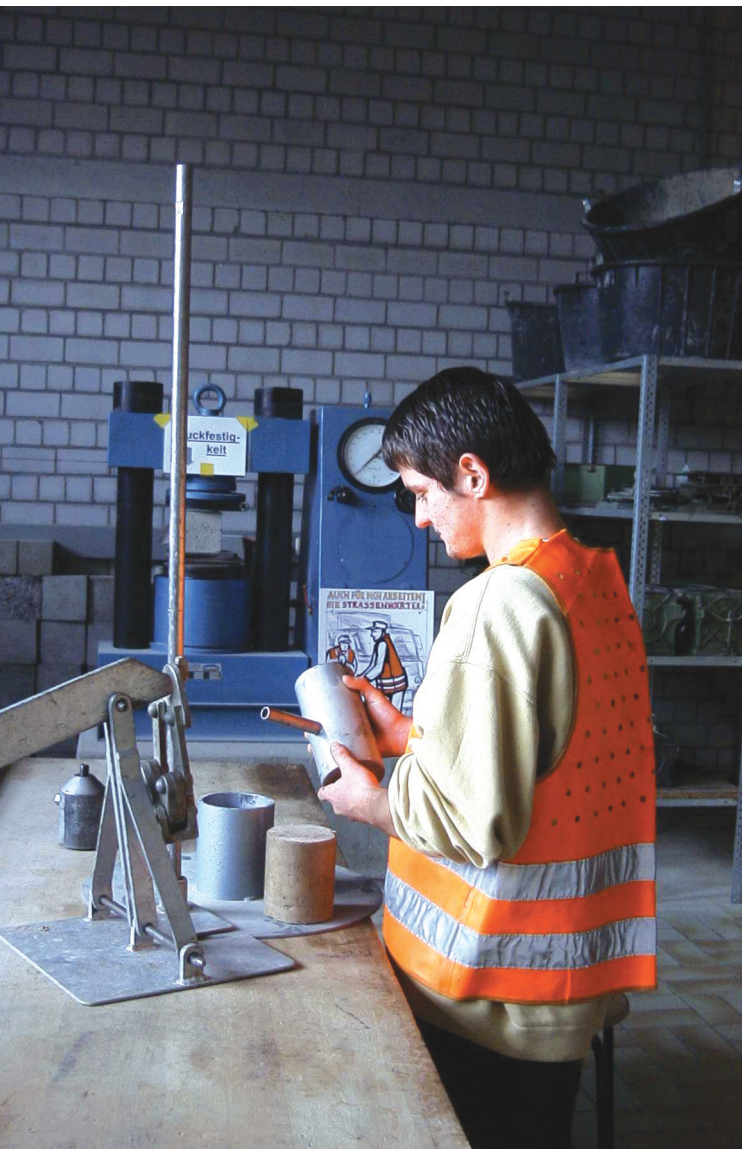
Vorbereitung eines Proctorversuchs
