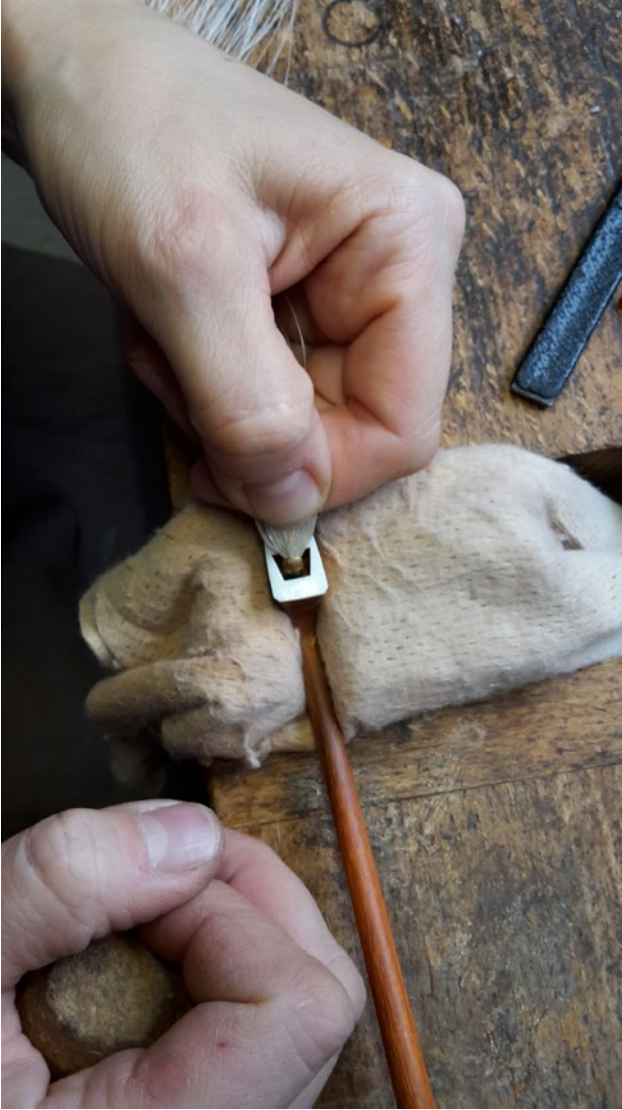
Abbildung 10: Einsetzen des Haarbezuges in den Bogenkopf G. Spätling
