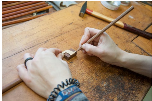
Abbildung 1: Aufzeichnen des Bogenkopfes nach Modell N. Kunz
