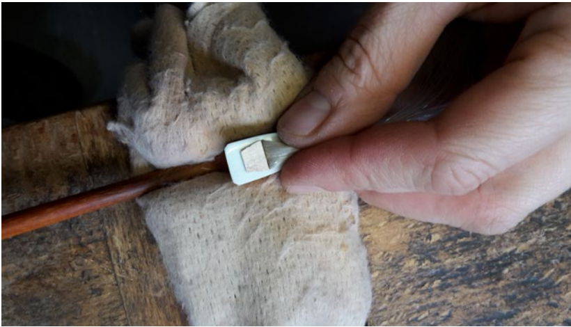
Abbildung 13: Haarbezug mit Kopfkeil im Kopf befestigen G. Spätling
