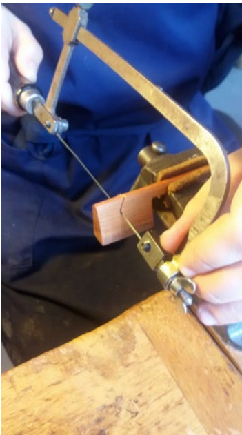
Abbildung 17: Bogenkopf aussägen G. Spätling
