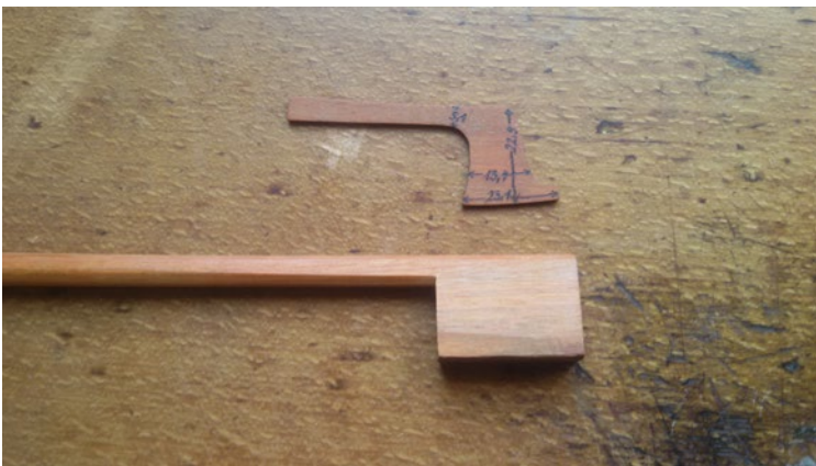
Abbildung 14: Rohre Stange mit Kopf-Schablone G. Spätling
