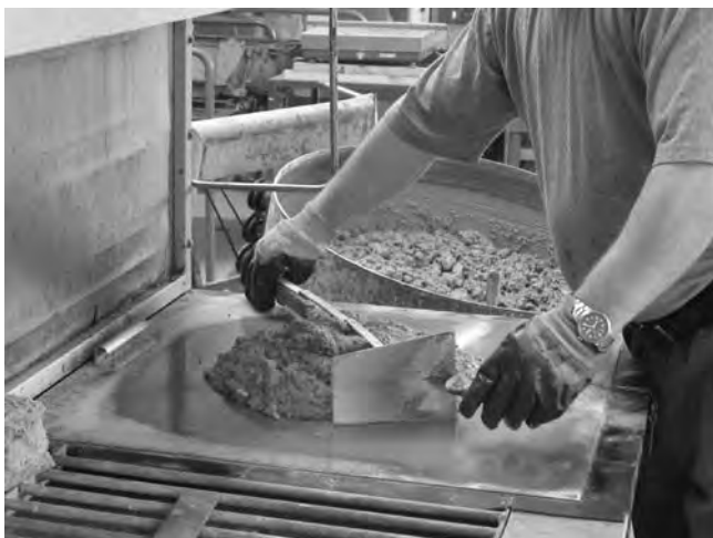
Bestimmung des Ausbreitmaßes von Frischbeton
