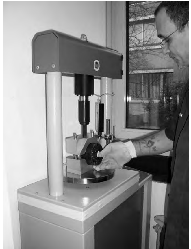
Marshalltest am Asphaltprobekörper
