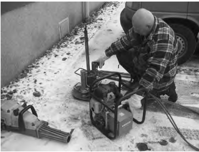
Felduntersuchungen: Ziehen des Gestänges einer schweren Rammsondierung mit Hilfe eines hydraulischen Ziehgerätes
