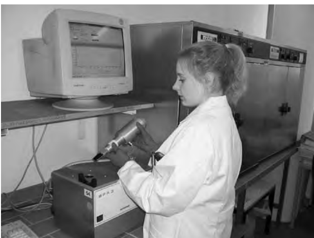
Automatische Prüfung des Brechpunktes einer Bitumenprobe
