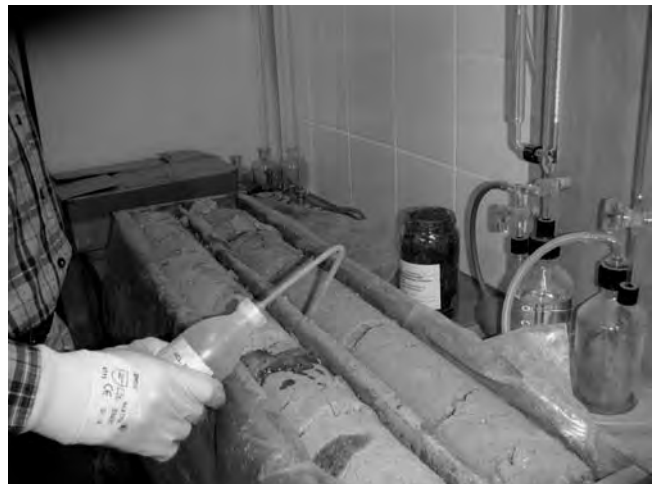
Bohrkern- und Einzelprobenbeurteilung (Boden-/Felsansprache) mit Überprüfung des Kalkgehaltes durch einen Salzsäuretest.
