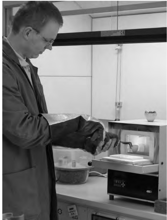
Glühverlustbestimmung an einer Zementprobe
