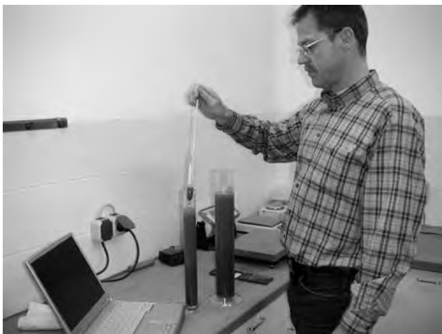
Schlammanalyse mit Einsatz eines Aräometers zur Bestimmung der Korngrößenverteilung von feinkörnigen Böden
