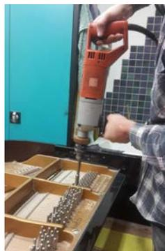
Abbildung 7: Ausdrehen der alten Wirbel (Stimnnägel) an einem Klavier
