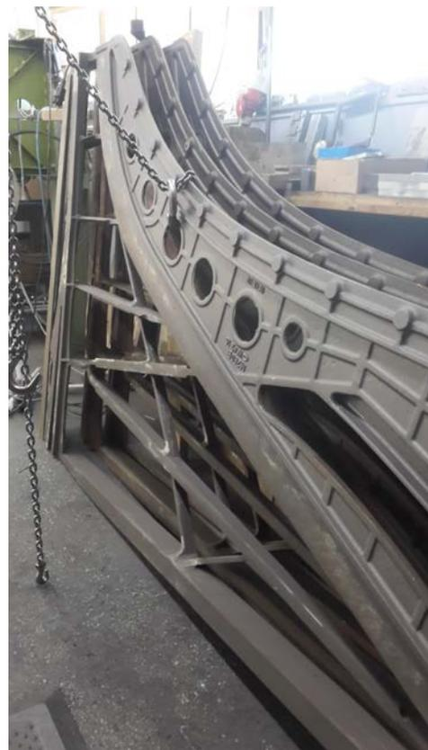
Abbildung 27: Gussrahmen – Graugussplatten
