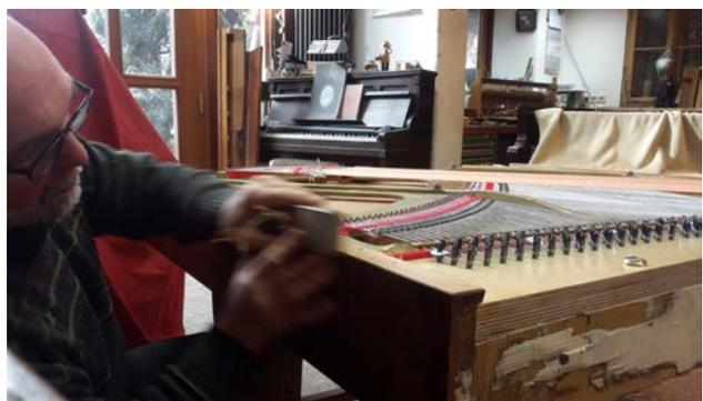
Abbildung 2: Bündighobeln der Füllleiste
