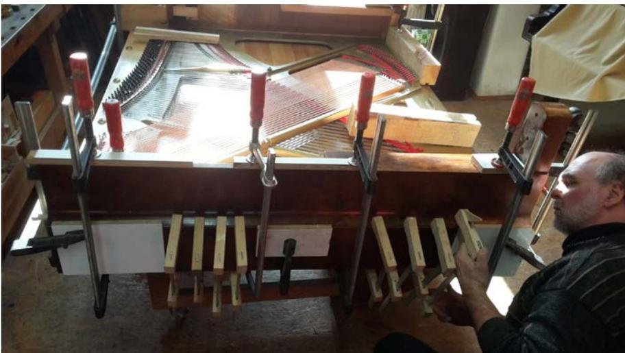
Abbildung 30: Verleimen einer abgetrennten Gehäuseseite
