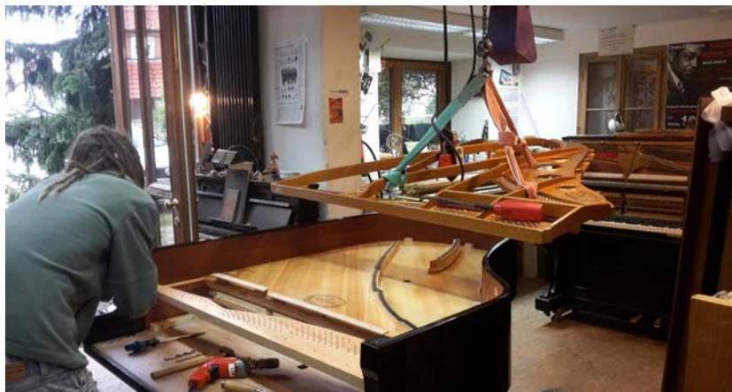
Abbildung 3: Einbau der Gussplatte (Gussrahmen) © Striegel
