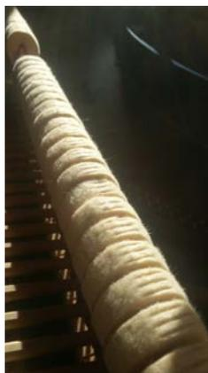
Abbildung 4: Starker Verschleiß an Flügelhammerköpfen
