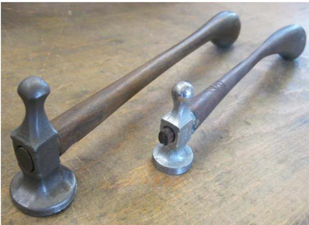
Abbildung 13: Fachrichtung Ziselierertechnik – Ziselierhämmer
