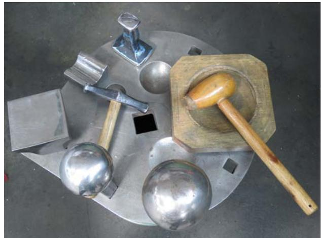
Abbildung 9: Fachrichtung Gürtlertechnik – Treibwerkzeuge
