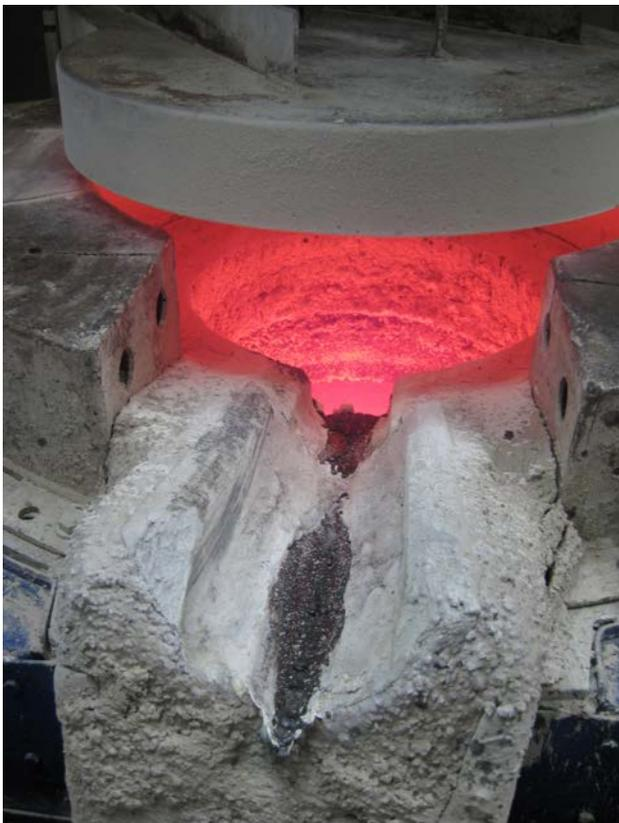
Abbildung 12: Fachrichtung Ziselertechnik – Schmelztiegel mit Ausgussrinne
