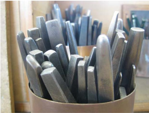
Abbildung 3: Fachrichtung Ziselertechnik – Punzen
