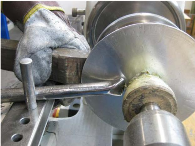
Abbildung 11: Fachrichtung Metalldrucktechnik – Aufziehen des Werkstückes mit Aufziehstahl und Druckspeitel
