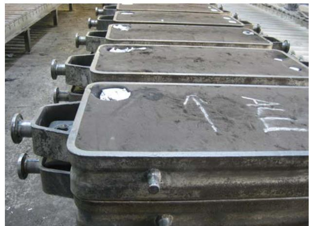
Abbildung 17: Fachrichtung Ziseliertechnik – Sandgussformen
