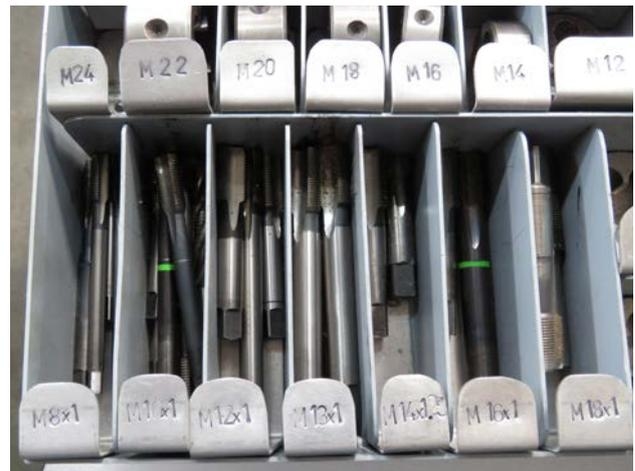
Abbildung 4: Fachrichtung Gürtlertechnik – Gewindeschneider
