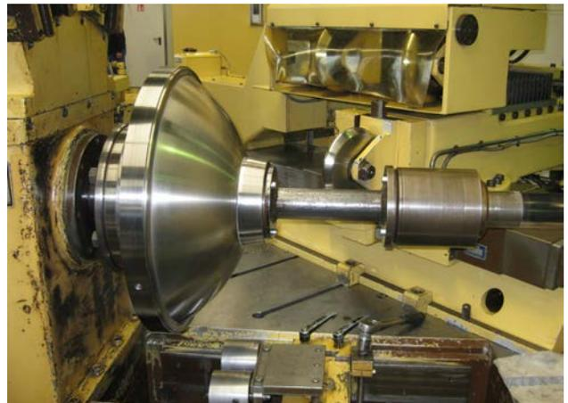
Abbildung 14: Fachrichtung Metalldrücktechnik – aufgerüstete PNC-gesteuerte Drückmaschine
