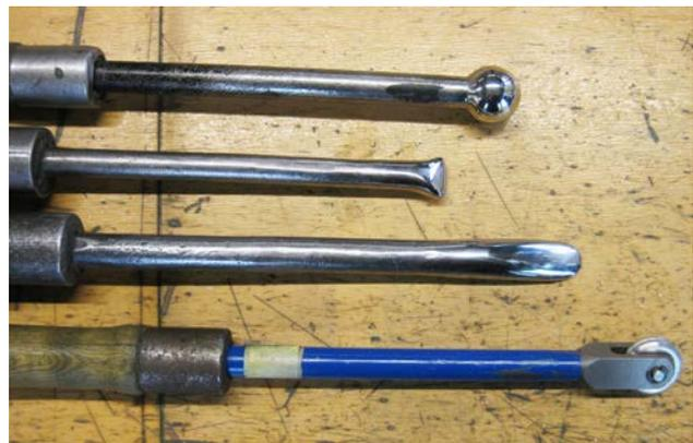
Abbildung 2: Fachrichtung Gürtlertechnik – Kugelstahl, Aufziehstahl, Langstahl, Wulstrolle
