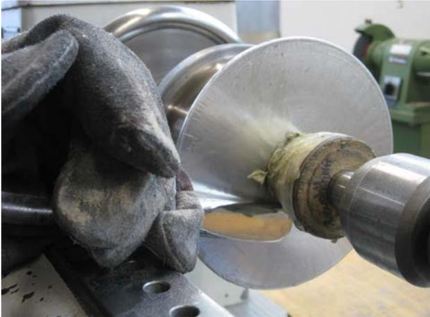
Abbildung 19: Fachrichtung Metalldrücktechnik – Drücken mit Langstahl
