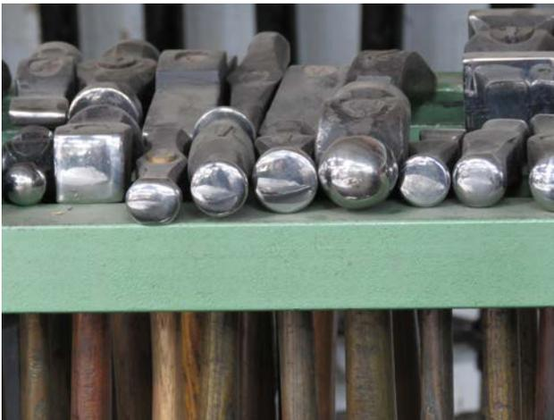
Abbildung 8: Fachrichtung Gürtlertechnik – Treibhämmer
