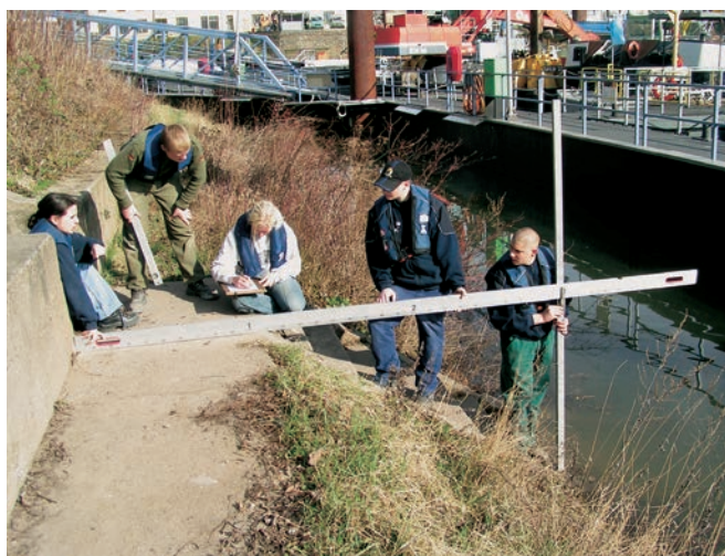
Durchführen einer Staffelmessung für ein Uferanschlussprofil
