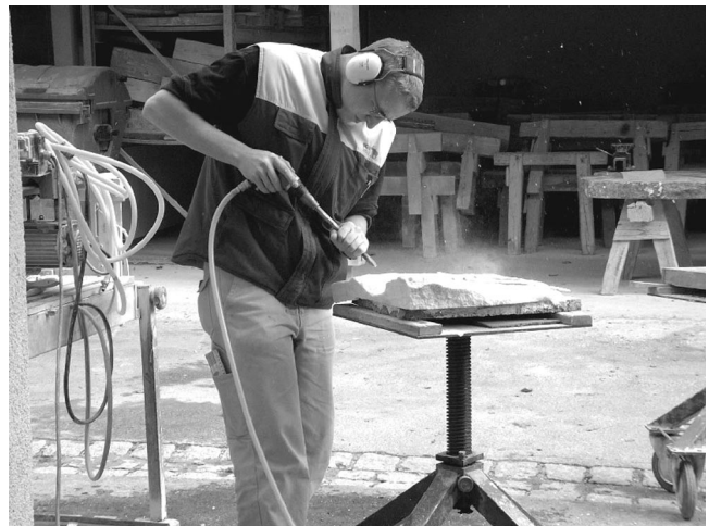
Abb.3 Arbeiten in Hüfthöhe
