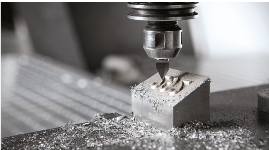
Abbildung 5: Herstellung eines Formeinsatzes (Bornemann GmbH)
