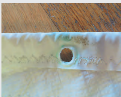
Abb. 54: Defekte Naht nachnähen
