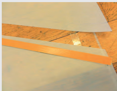
Abb. 47: Die Naht kann aufgrund der Abnäher am Vor- und Achterliek breiter sein oder parallel zum Kleber abgeschnitten werden.
