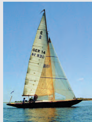
Abb. 20: Horizontal- und Triradialschnitt
