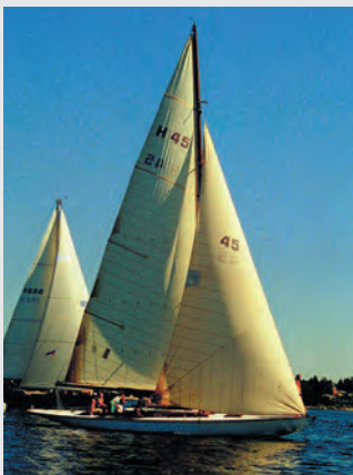
Abb. 19: Horizontal- und Laschenschnitt
