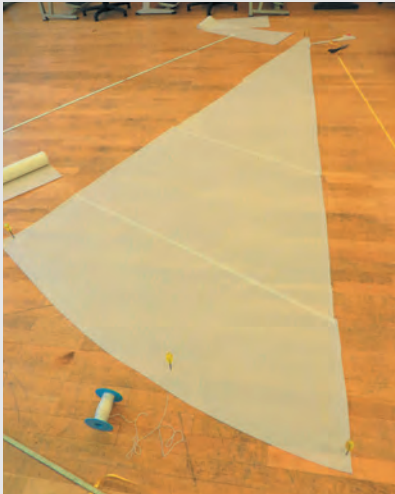
Abb. 40: Die Position der tiefsten Profiltiefe (Draft) wird festgelegt ...
