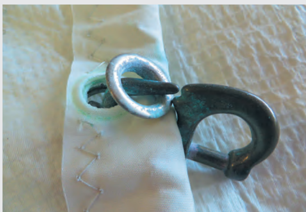
Abb. 49: Korrodierte alte Öse
