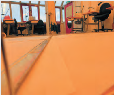
Abb. 43: Eine Straklatte wird angelegt ...
