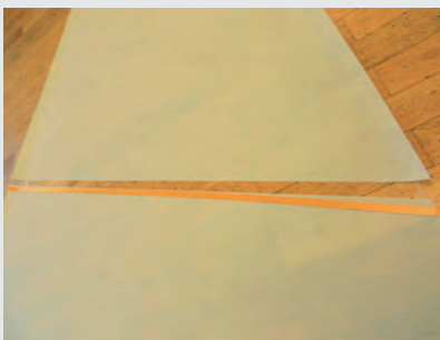
Abb. 46: Am Bleistiftstrich wird doppelseitiges Klebeband aufgebracht.
