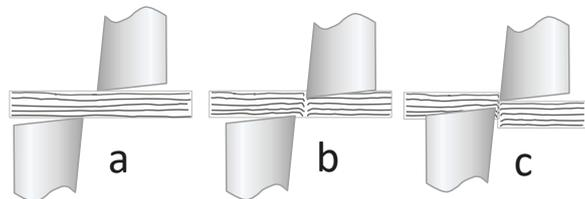
**a) Stauchen, einkerben: Der Werkstoff wird an der Ober- und Unterseite eingedrückt**
