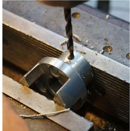
Abbildung 6: Bohren einer Kupplung
