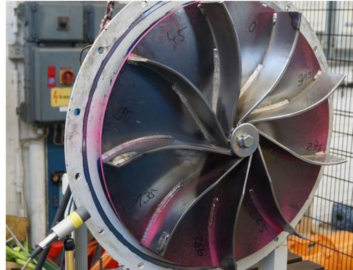
Abbildung 16: Auswuchten eines Schaufelrades
