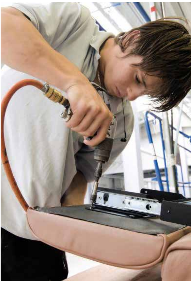
Abbildung 5 – Anbringen einer Halterung für eine Nackenstütze © HDS
