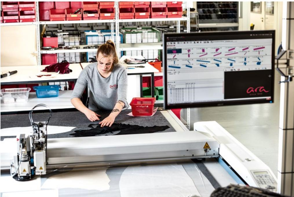
Abbildung 3: Zuschneiden des ausgelegten Leders (ara Shoes AG)
