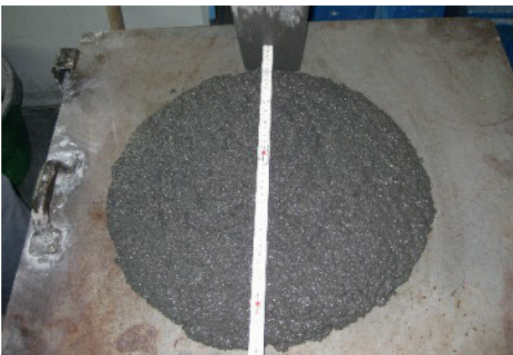
Abbildung 7-9: Ausbreitmaß: Befüllen, 15-maliges Anheben, Bestimmung © Krauskopf
