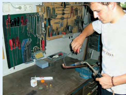
Kupferleitung weich löten
