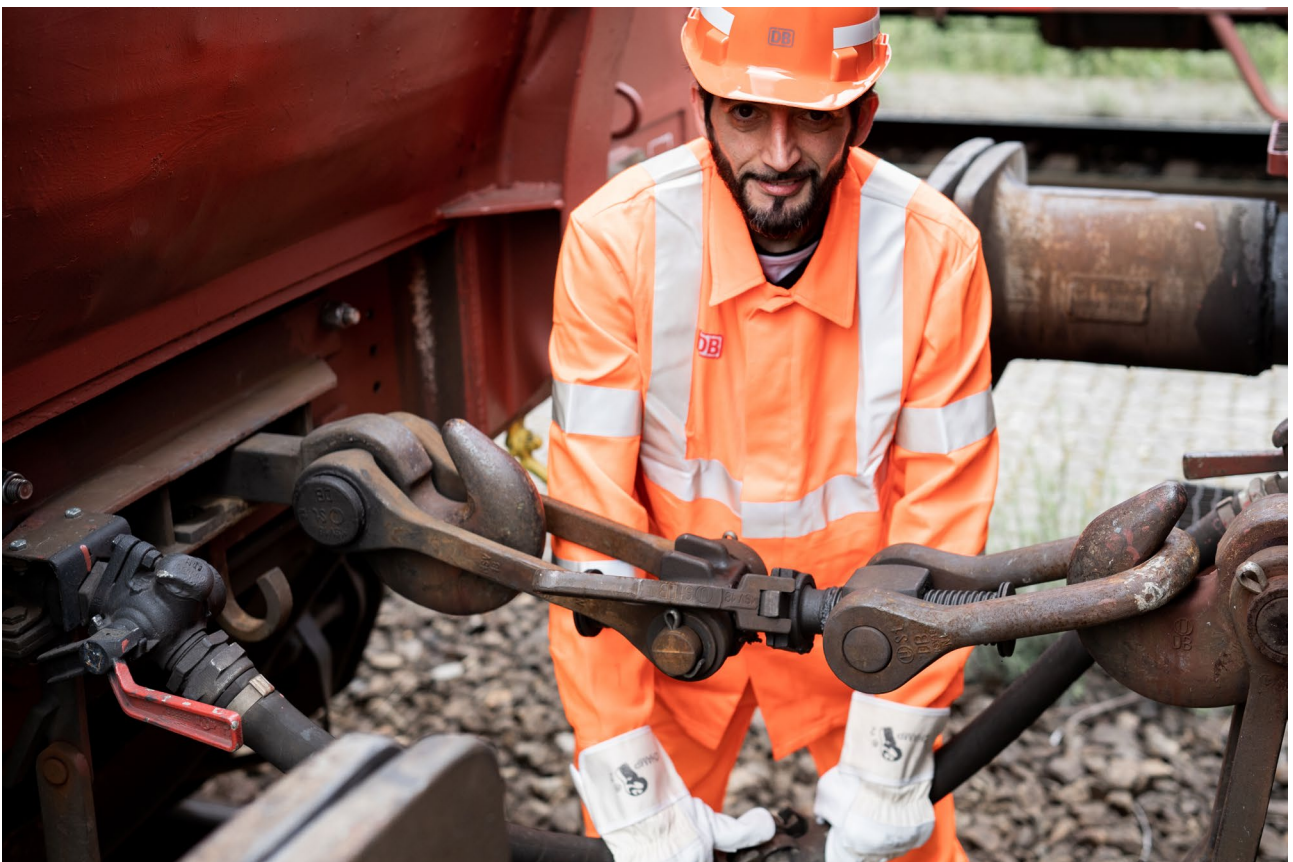
Rangierbahnhof München-Nord, Bremsschläuche werden verbunden (Quelle: Deutsche Bahn AG/Patrick Kuschfeld)
