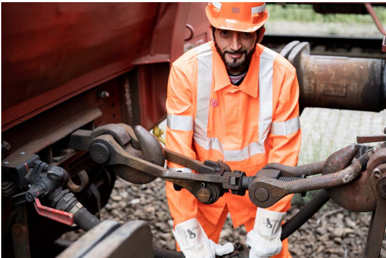
Abbildung 9: Rangierbahnhof München-Nord, Bremsschläuche werden verbunden (Quelle: Deutsche Bahn AG/Patrick Kuschfeld)
