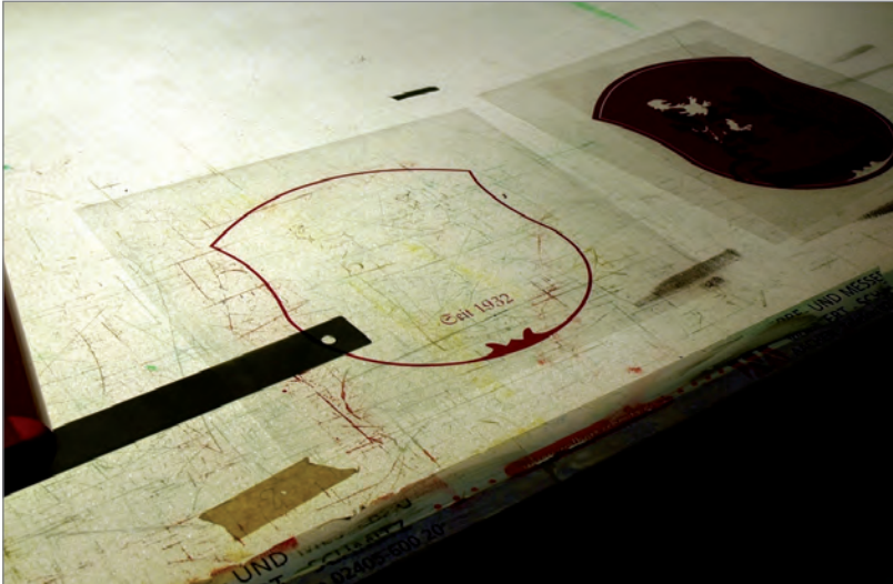
Manuelle Herstellung eines Maskierfilms für den Siebdruck © Markus Beusch
