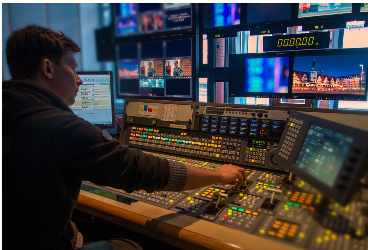
Abbildung 14: Vorbereitung einer Sendung am Bildmischer (Quelle: MDR/Urbach)
