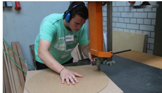
Zuschnitt der Wellpappe an der Bandsäge
