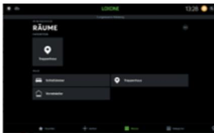
Die Loxone App bietet die Möglichkeit die im Miniserver programmierten Funktionen auch durch mobile Endgeräte auszuführen. Allerdings arbeitet die App raumbasiert, so dass die Funktionsbausteine, sowie die Ein- und Ausgänge noch zugeordnet werden müssen.
