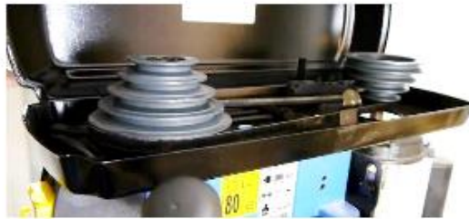
Ist-Zustand: Die Drehzahl kann in Stufen über einen Keilriemen eingestellt werden.
