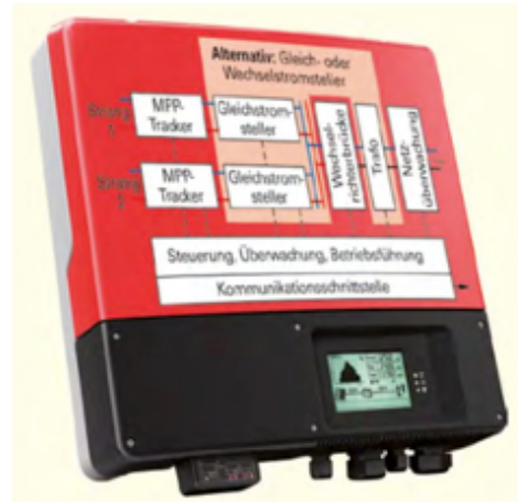
Abbildung 5: Wechselrichter mit Blockschaltbild
