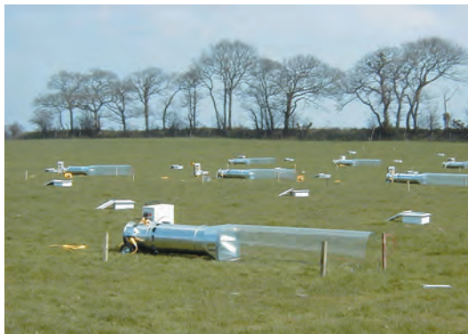
Einrichtungen zur Probenahme von Lachgasemissionen auf einem Versuchsfeld
