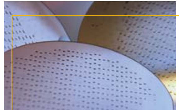
Mit Nanopolitur behandelte Vorlage für Hightech-Computerchips
