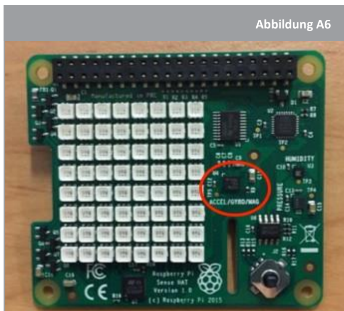
↑ IMU-Sensor im Sense HAT
