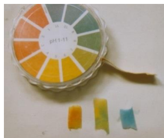
Abb. 2+3: Indikatorpapier zeigt Änderungen der Konzentration an \text{H}_3\text{O}^+ -Ionen an – als Farbumschlag entsprechend dem pH-Wert. Bild 3 rechts zeigt die Kreuzprobe: Das Indikatorpapier wird vom Ammoniakgas blau gefärbt – es reagiert basisch.
