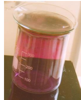
Abb. 2: Iodkristalle sublimieren beim Erwärmen. Am kalten Uhrglas oben resublimiert der violette Ioddampf wieder zu kleinen, schwarzen Kristallen.
