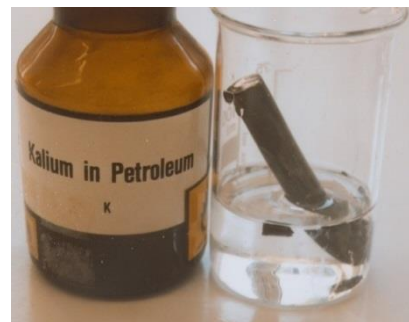
Abb. 1: Kalium kann sogar Wasser zu Wasserstoff reduzieren. Es wird zum Schutz vor Luftfeuchtigkeit unter Petroleum aufbewahrt.
