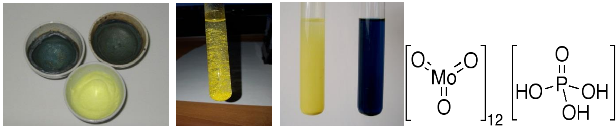
Abb. links: Aufschlüsse von MnO 2 (oben, blaugrünes Manganat) und Cr 2 O 3 (unten, gelbes Chromat) mit der Oxidationsschmelze, Abb. Mitte: Iodid-Nachweis mit Pb(NO 3 ) 2 -Lösung, rechts: PO 4 3- -Nachweis mit Molybdatlösung als Positivprobe (gelb), gestört (blau) und die Strukturformel. (Bildquelle links: Eig. Foto, Wikipedia, CC BY-SA 3.0, Mitte: Stefano sct - Own work, CC BY-SA 4.0, https://commons.wikimedia.org/w/index.php?curid=43814868 , rechts: By Oguenther - Own work, CC BY-SA 3.0, https://commons.wikimedia.org/w/index.php?curid=22872509 )
