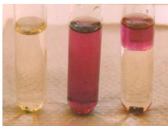
Abb. 4: Iod in Wasser (links), in Hexan (Mitte) und in Wasser mit Hexan (Eig. Foto)
