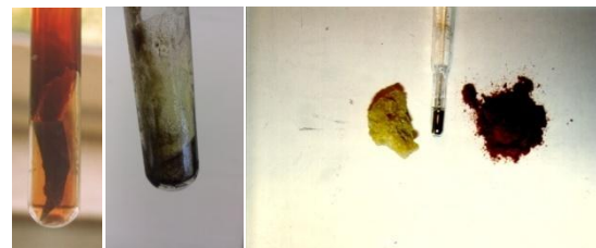
Abb. 28: Links reagiert ein Kupferblech mit heißem Schwefeldampf. Das Bild in der Mitte zeigt unten die neue, schwarze Verbindung von Kupfer und Schwefel, das Kupfersulfid. Rechts sind Schwefelpulver (links) und Quecksilber (mittig, im Thermometer) zu sehen. Rechts davon die Verbindung Quecksilbersulfid. Sie ist knallrot und wurde früher Zinnober genannt (Eig. Fotos).
