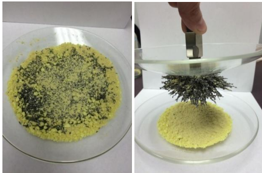
Abb. 13: Links ein Gemisch aus Schwefel- und Eisenpulver, rechts dessen Trennung mit Hilfe eines Magneten (Magnetscheiden).
