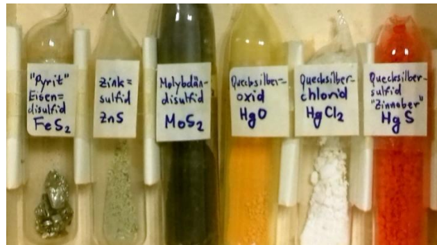
Abb. 29: Verbindungen einiger Metalle mit Schwefel, Sauerstoff und Chlor, von links nach rechts: Eisendisulfid, Zinksulfid, Molybdändisulfid, Quecksilberoxid, Quecksilberchlorid und Quecksilbersulfid (eig. Fotos).
