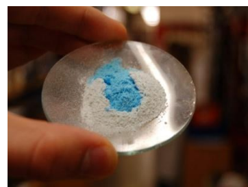
Abb. 20: Wasserzugabe zu getrocknetem und somit wasserfreiem Kupfer(II)sulfat – das weiße Salz wird wieder blau (Abb. gemeinfrei)
