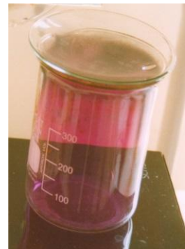
Abb. 2: Iodkristalle sublimieren beim Erwärmen direkt, ohne vorher zu schmelzen. Am kalten Uhr glas oben resublimiert der violette Ioddampf wieder zu kleinen, schwarzen Kristallen (Eig. Foto)
