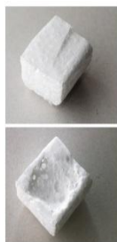
Abb. 104: Aceton als Lösemittel. Rechts ist zu sehen, wie einige Tropfen Aceton den Kunststoff Styropor auflösen (Abb. links gemeinfrei, Bildquelle rechts: Simon A. Eugster / CC BY-SA ( https://creativecommons.org/licenses/by-sa/3.0/ ))
