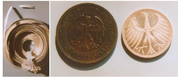
Abb. 27: Links Magnesiumband, rechts zwei Silbermünzen. Die linke, dunkle Silbermünze ist im Laufe der Zeit angelaufen: Aus Schwefel, der z.B. in Eiweiß und Schweiß vorkommt, und Silber hat sich schwarzes Silbersulfid gebildet (Eig. Fotos).
