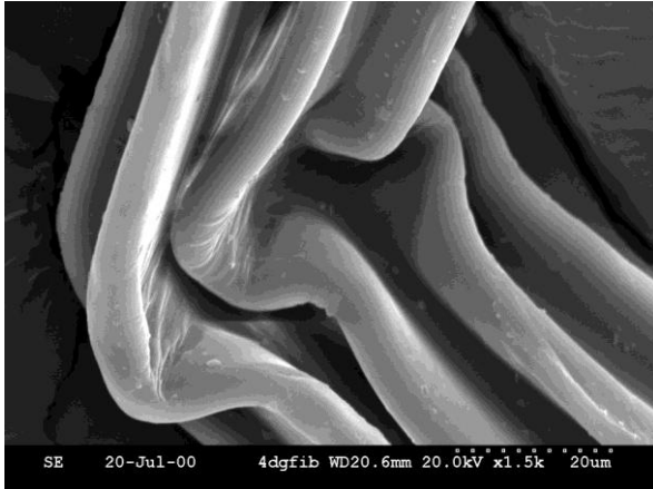
Abb. 102: Polyesterfaser im Rasterelektronenmikroskop (Bildquelle: Von en:User:Pschemp - Eigenes Werk, CC BY-SA 3.0, https://commons.wikimedia.org/w/index.php?curid=652642 )
