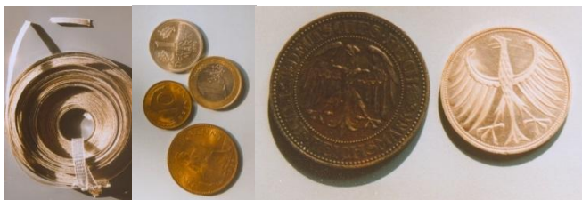
Abb. 22 (links): Magnesiumband, Abb. Mitte: Buntmetalle werden als Münzmetalle genutzt, oft auch in Form von Legierungen wie z.B. Messing. Abb. 20 (rechts): Das Edelmetall Silber läuft mit der Zeit schwarz an, weil sich Silbersulfid bildet – eine chemische Reaktion mit Schwefel. (Bildquellen Abb. 1-9: Eig. Fotos).
