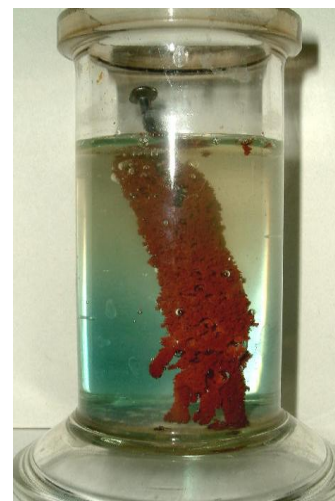
Abb. 3.16: Ein Eisennagel in Kupfersulfatlösung – nach mehreren Stunden entsteht ein brauner Belag von Kupfer und die blaue Lösung entfärbt sich (Bildquelle: Von H. Hoffmeister - http://hoffmeister.it/chemie/16-elektrochemie-I.zip , GFDL, https://commons.wikimedia.org/w/index.php?curid=11482497 )
