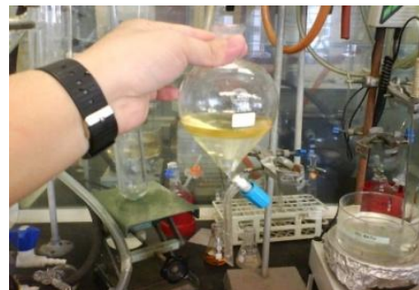
Abb. 11d: Ölabscheidung im „Florentiner Topf“ (links) und im Scheidetrichter (rechts, beide Abb. gemeinfrei)
