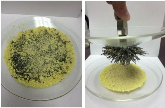
Abb. 11f: Links ein Gemisch aus Schwefel- und Eisenpulver, rechts dessen Trennung mit Hilfe eines Magneten (Magnetscheiden).
