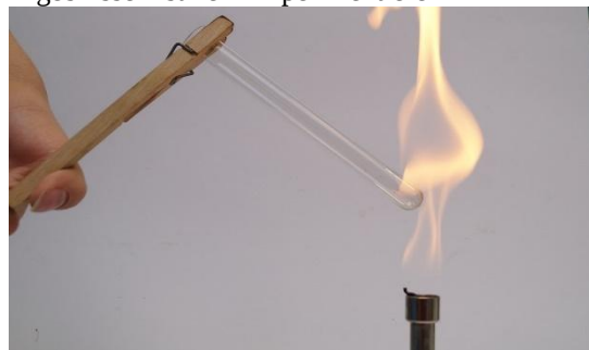
Abb. 27f: Erhitzen im Reagenzglas: Die Reagenzglasklammer hilft, Abstand zur Flamme zu halten. (Beide Abb. gemeinfrei)
