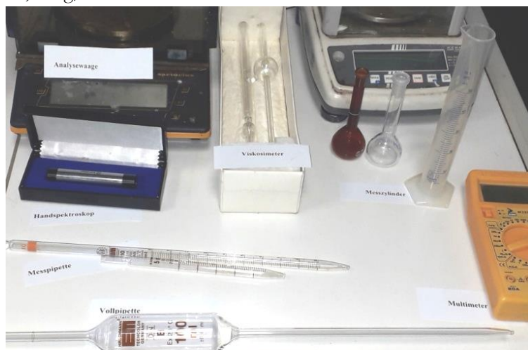
Abbildung: Messgeräte zur Erfassung von Messwerten und Stoffeigenschaften - hier von links oben im Uhrzeigersinn: Waage (für Masse / Gewicht), Viskosimeter (Zähflüssigkeit), Messzylinderr (Volumen), Multimeter (elektr. Leitfähigkeit), Voll- und Messpipette (Volumen), Handspektroskop (Farbanteile im Licht) (Eigenes Foto)
