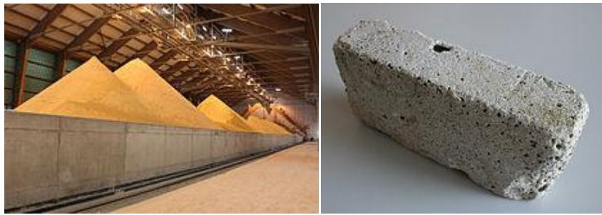
Abb. 1.56: Links REA-Gips aus einer Rauchgasentschwefelungsanlage , rechts ein um ca. 1870 aus Hochbrandgips gegossener Mauerstein
