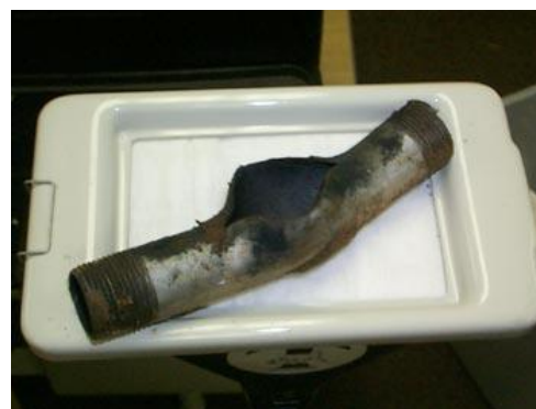
Abb. 2.16: Explodierte schwarzpulvergefüllte Rohrbombe aus einem FBI-Versuchsaufbau (Bildquelle: FBI, gemeinfrei)
