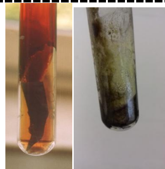
Abb. 1.23: Kupfer und Schwefel im Reagenzglas beim Erhitzen und rechts nach Abklingen der Reaktion und Abkühlen der Produkte (Eig. Fotos).
