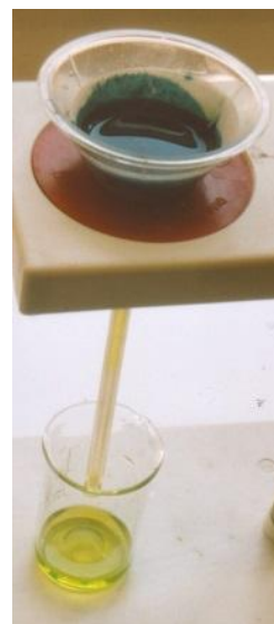
Abb. 1.38: Abfiltrieren eines Niederschlages des frisch ausgefällten, unlöslichen Salzes „Berliner Blau“, unten das Filtrat enthält noch gelb gelöstes Blutlaugensalz (Eig. Foto).
