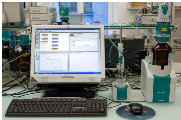
Abb. 5.4: Automatisches Titrationsgerät (Abb. Gemeinfrei)
