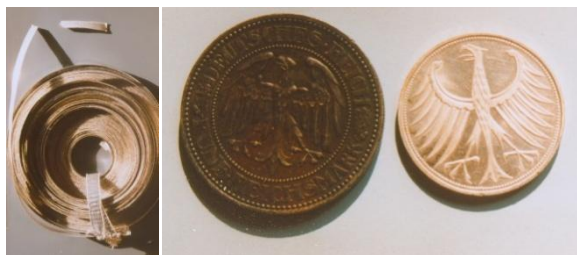
Abb. 1.7: Links Magnesiumband, rechts zwei Silbermünzen. Die linke, dunkle Silbermünze ist im Laufe der Zeit angelaufen: Aus Schwefel, der z.B. in Eiweiß und Schweiß vorkommt, und Silber hat sich schwarzes Silbersulfid gebildet (Eig. Fotos).
