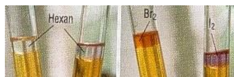
Abb. 2.13: Halogenidnachweis mit Chlorwasser und Hexan (Eig. Fotos)
