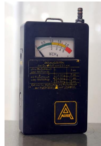
Abb. 1.2: Messgerät für die Grubengas- bzw. Methankonzentration der Luft (Zeche "Zollern 2/4" in Dortmund, Bildquelle: ByNightflyer - Ownwork, CC BY 4.0, https://commons.wikimedia.org/w/index.php?curid=77924308 )
