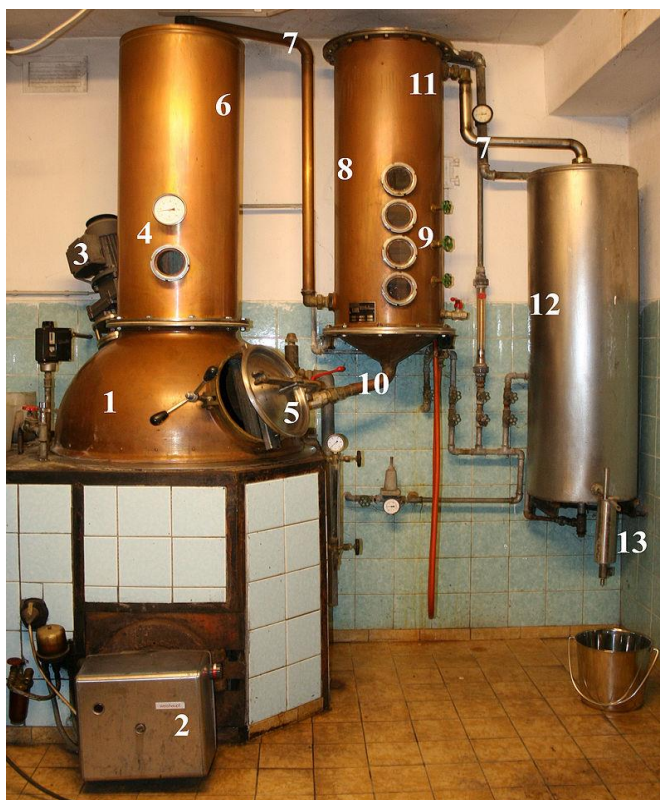
Abb. 4.7: Schnapsbrennanlage zur Destillation der gärenden Rohmasse (Brennanlage für Abfindungsbrennerei; Legende: 1 Brennbrase 2 Befeuerung 3 Rührwerk 4 Fenster und Thermometer 5 Öffnung 6 Helm 7 Geistrohr 8 Kolonne 9 Glockenböden 10 Überlauf 11 Dehlegmator 12 Kühler 13 Vorlage, Abb. gemeinfrei)
