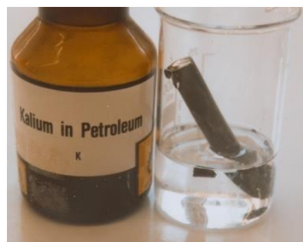
Abb. 2.23: Paraffin ist so reaktionsträge, dass darin sogar hoch reaktive Stoffe wie Kalium aufbewahrt werden können (Eig. Foto). Zu diesem Zweck eignet sich auch Petroleum (von lat. „Steinöl“, Kurzform „Petrol“), ein ebenfalls flüssiges Stoffgemisch von Kohlenwasserstoffen. (Eig. Foto)
