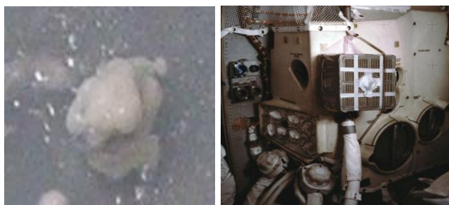
Abb. 2.3: Links die Verbindung Lithiumhydroxid, hergestellt aus etwas Lithiummetall und einem Tropfen Wasser, rechts der Lithiumhydroxid-Luftfilter auf Apollo 13 (von den Astronauten gebauter, provisorischer CO 2 -Absorberfilter in Betrieb, Bildquelle: NASA / beide Abb. gemeinfrei)
