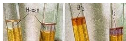
Abb. 2.13: Halogenidnachweis mit Chlorwasser und Hexan (Eig. Fotos)
