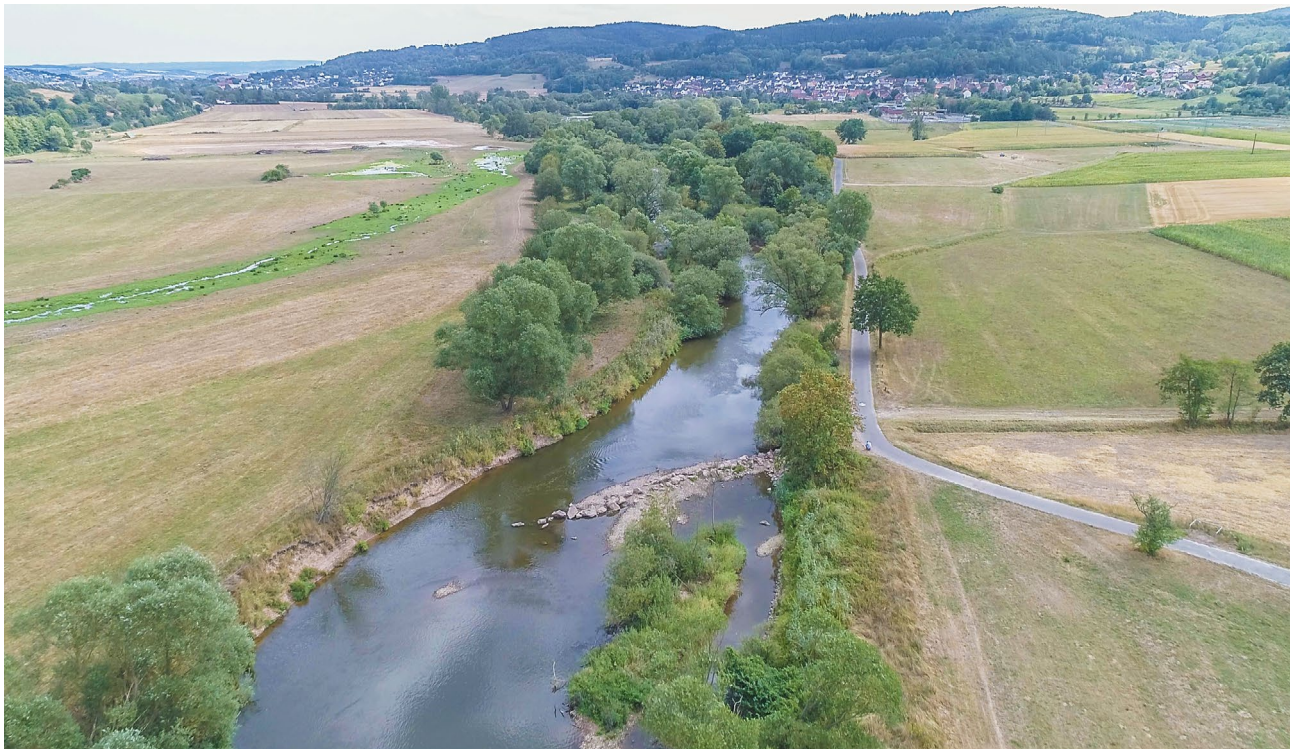
Ufererosion an Strömungslenker in der Fulda bei Alheim (2018). Große Steine aus dem ehemaligen Uferverbau sorgen als Strömungslenker für eine eigendynamische Entwicklung – auch eine Aufwertung des Naturerlebnisses entlang des Fuldaradwegs.
