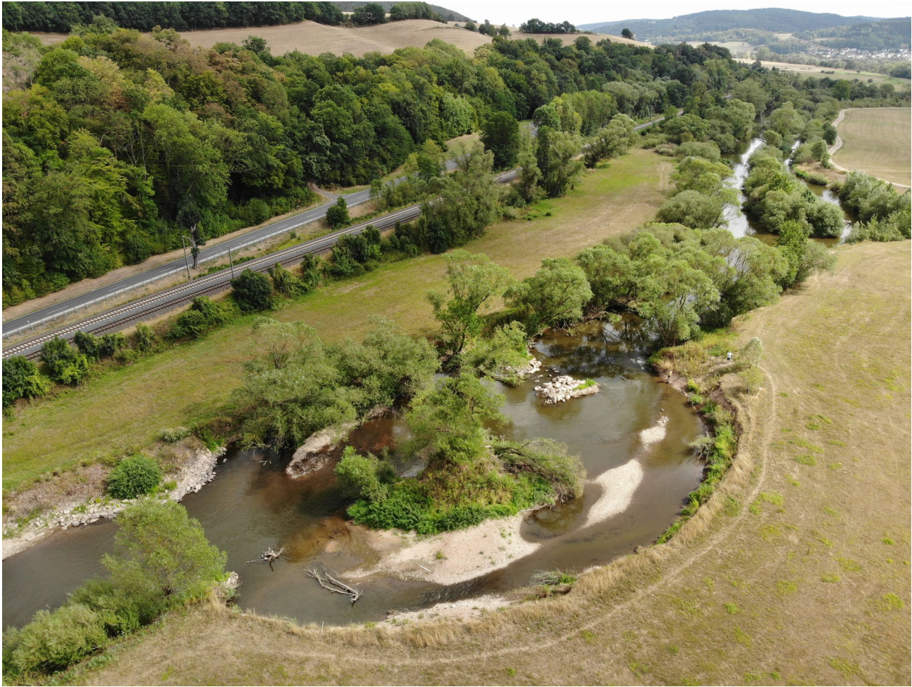
Initialmaßnahmen zur eigendynamischen Entwicklung der Fulda bei Alheim (2018). Durch kleine Maßnahmen wie Strömungslenker lassen sich Veränderungen im Gewässer, wie diese großzügige Aufweitung, anstoßen.
