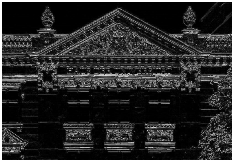
Abbildung 4: Feature Map nach Anwendung des horizontalen Sobel-Filters auf "Haus der Universität" (Originalbild: Mayr, I. Haus der Universität /©HHU).
