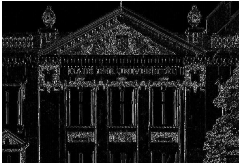
Abbildung 5: Feature Map nach Anwendung des vertikalen Sobel-Filters auf "Haus der Universität" (Originalbild: Mayr, I. Haus der Universität /©HHU).
